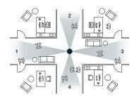
360° Hallway Installation Sensor's max tilt: 60°
